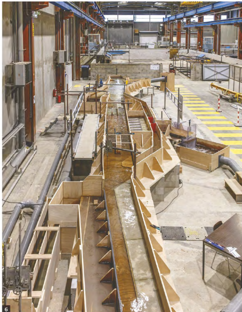
5 - La maquette au 1/12 permet d'étudier les phénomènes complexes qui se produisent au niveau des pompes de la station d'épuration. 6 - Les différents canaux qui l'alimentent ont été modélisés en bois sur 23,5 m de long, soit près de 300 m dans la réalité.
