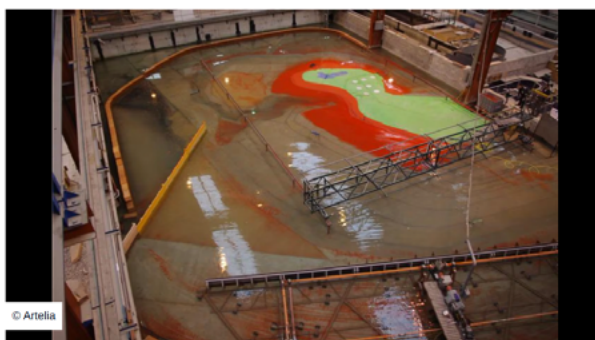
Laboratoire Artelab Maquette hydraulique physique d'aménagements littoraux et estuariens
