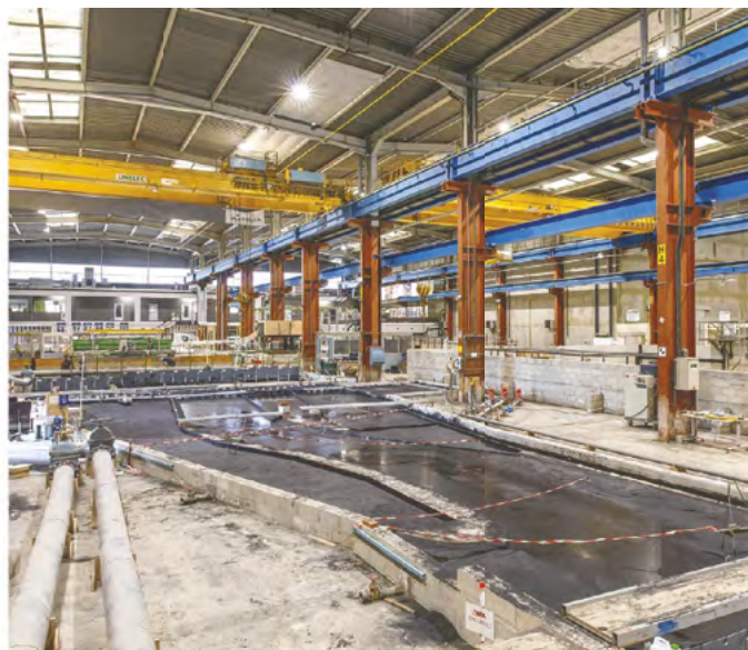
Pour améliorer le transit sédimentaire au travers de la retenue du barrage pakistanais de Sukkur, sur l'Indus, Artelia mène des études à l'aide de modèles numériques 2D, 3D et d'un modèle physique à l'échelle 1/75.
