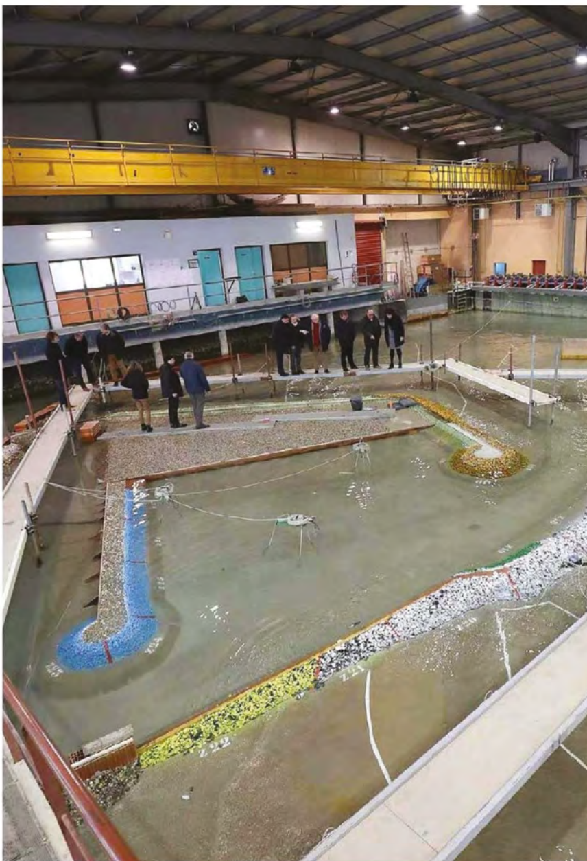
Le nouveau laboratoire de modélisation hydraulique d'Artelia permettra de combiner des variables : marées, houle, quai, embarcations etc. JEAN-CHRISTOPHE SOUNALET - ARTELIA
