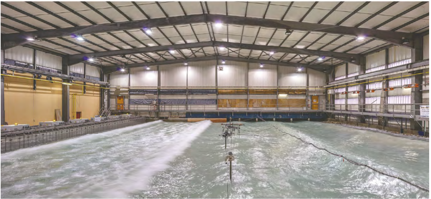
Installé dans un bassin de 40 m de long, le nouveau générateur de houle permet de simuler des vagues de grandes amplitudes dans plusieurs directions.
