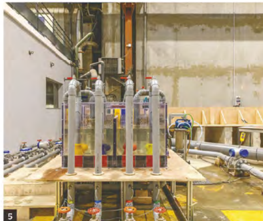
5 - La maquette au 1/12 permet d'étudier les phénomènes complexes qui se produisent au niveau des pompes de la station d'épuration. 6 - Les différents canaux qui l'alimentent ont été modélisés en bois sur 23,5 m de long, soit près de 300 m dans la réalité.
