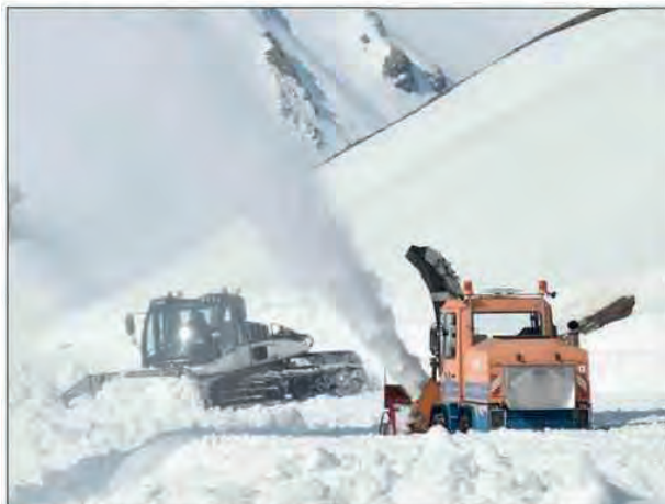
Le travail de la dameuse facilite celui de la fraiseuse.
